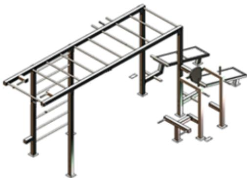
EQUIPAMENTO FABRICADO EM TUBOS QUADRADOS DE AÇO INOX 304 DE 80MM X 80MM X 2MM; 50MM X 30MM X 2 MM; TUBO REDONDO EM AÇO INOX DE 1 1/4" X 2MM; 2" X 2MM; CHAPA LISA DE 3 MM ; 4MM E 2MM. EQUIPAMENTO COM ACABAMENTO POLIDO. PRANCHA ABDOMINAL COM ESTRUTURA TUBULAR E FECHAMENTO EM CHAPA DE AÇO INOX.
