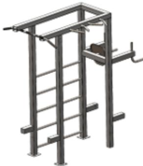
O EQUIPAMENTO DEVE SER FABRICADO EM COLUNAS DE AÇO INOX, DE SEÇÃO QUADRADA DE 3 1/2" X 3 MM, PEGADAS EM TUBO DE AÇO INOX REDONDO DE 1 1/2" X 2 MM; 1" X 2 MM; TODOS OS COMPONENTES EM AÇO INOX 304. EQUIPAMENTO COM FUNÇÕES NÃO ARTICULADAS E FIXADO ATRAVÉS DE CHUMBADORES. DIMENSÕES APROXIMADAS 4,6M DE LARGURA X 5,5M DE COMPRIMENTO X 2,5M DE ALTURA.
